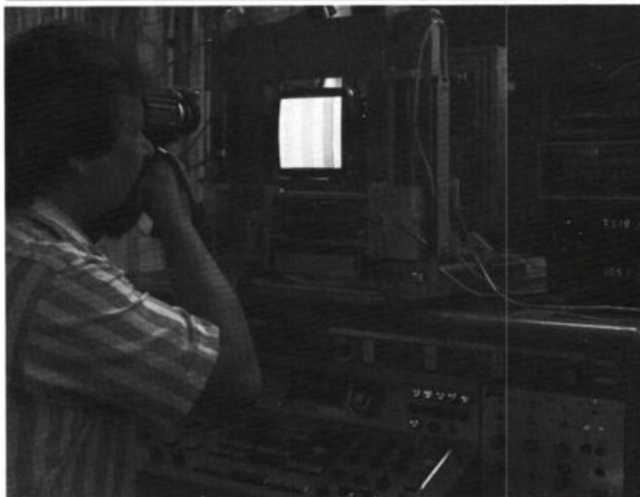
Luminantiemeting met microfotometer aan het beeldscherm van een 18-cm kleurenbeeldbuis voor toepassing in cockpit-monitoren (foto AEG).
